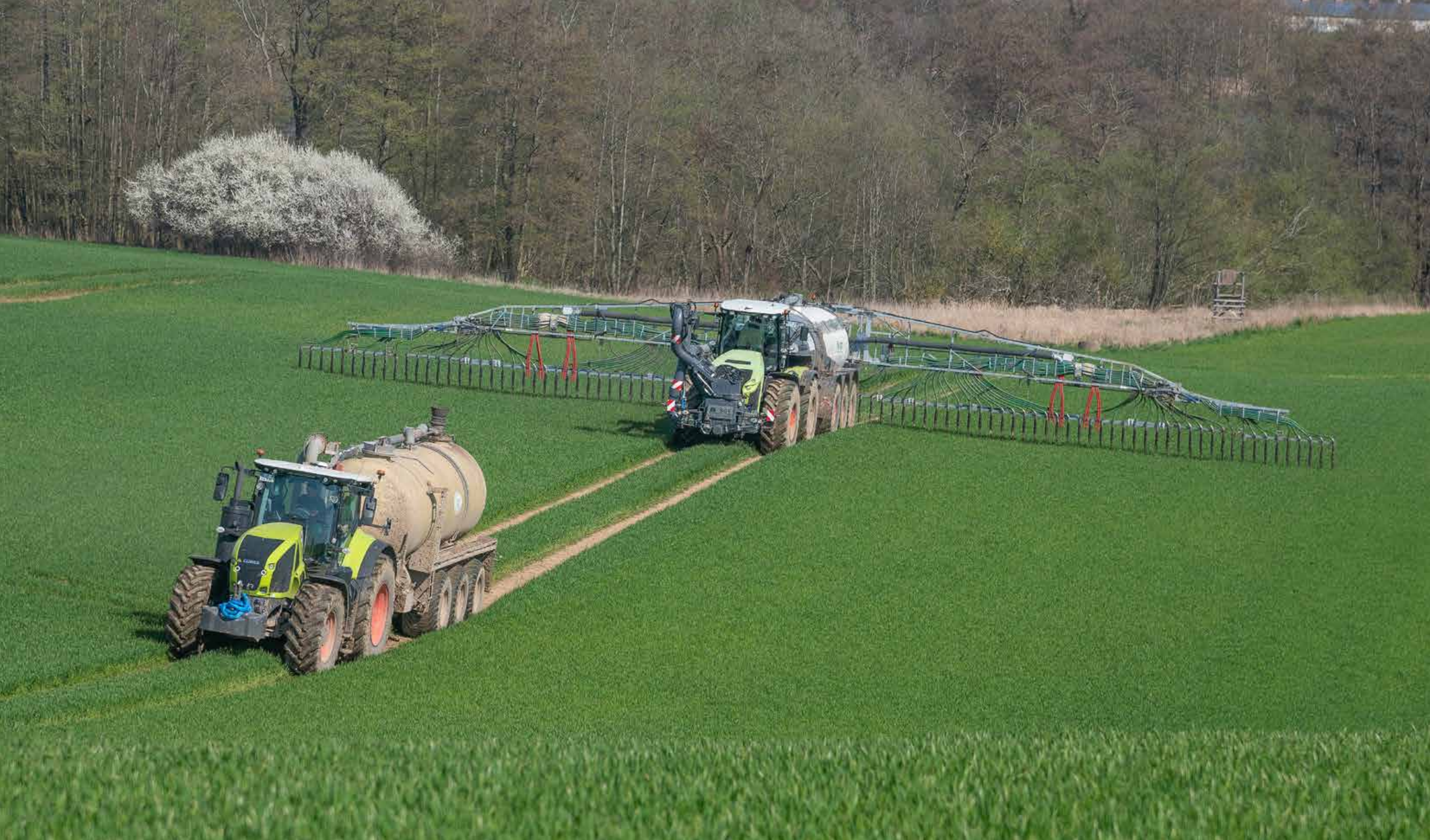
Claas Axion 930 mit Annaburger Zubringer und Xerion 4000 mit einem SGT Schwanenhals Güllefass
